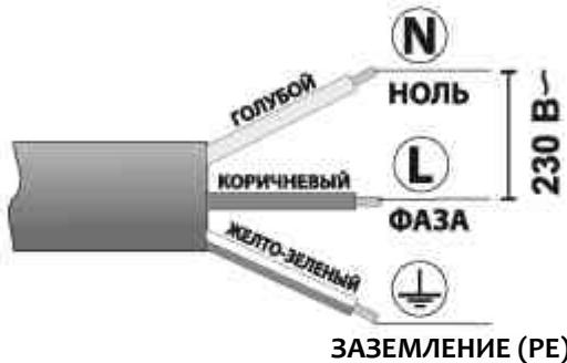
*Пример подключения сетевого кабеля.*
